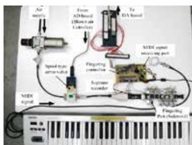
図8 管楽器の自動吹奏ロボット
