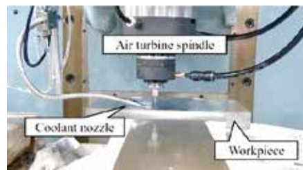
図3 エアタービンスピンドルの制御と切削加工
