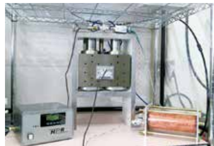
図4 電空ハイブリッド超精密鉛直位置決めステージ
