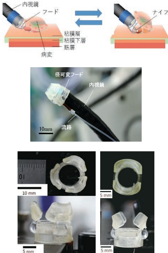
図4 液圧駆動径可変フード（先端の外径が9～14mmに可変） （上）内視鏡を用いた病変と粘膜の切除と内視鏡フード （中）内視鏡先端へ装着した径可変フード （下）径可変フード：3枚羽根（左），2枚羽根（右）
