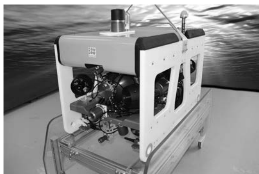
図7 海空研が開発したホバリング型AUV “ほばりん” の外観
