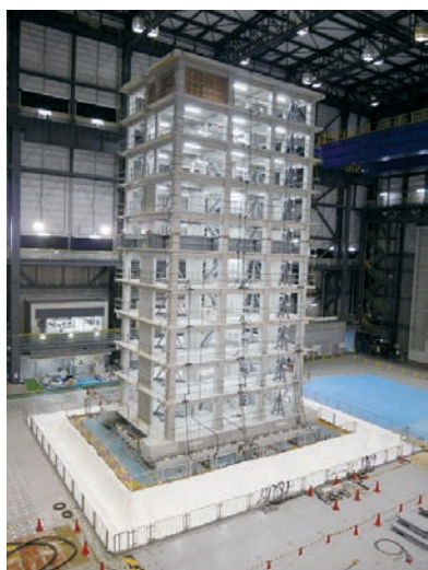
図6 10層RC建物実験試験体
