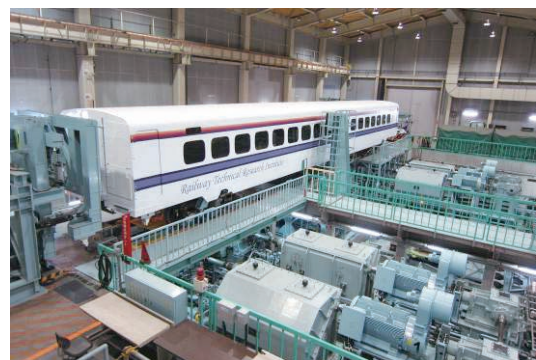
図2 現在の車両試験台
