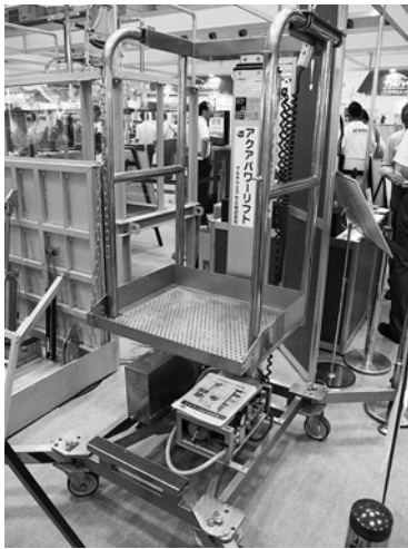
写真3 高所作業用水圧リフト
