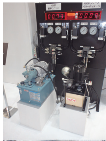
図1 可変容量ポンプユニット(常時運転)とアキュムレータ搭載間欠運転ポンプユニット積算・瞬時消費動力比較デモ
