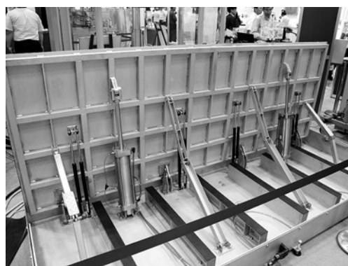
写真2 水道水圧シリンダ式防水板
