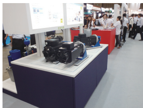
図3 ACサーボモータ駆動可変容量ポンプ（モータ回転数とポンプ容量の両方の可変駆動）
