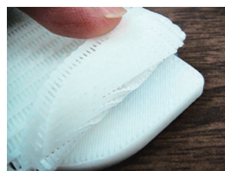
図5 剥離可能なサポートの例 図6 厚さ0.6mmの垂直壁
