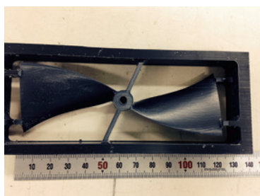
図5 プロペラの切削例
