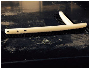
図9 積層造形法による部品製作
