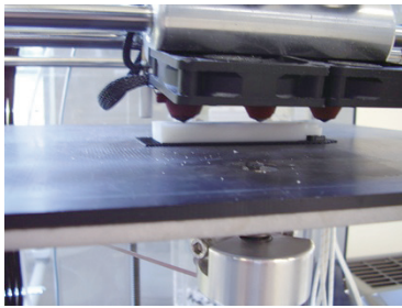
図7 積層造形法による部品製作
