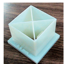
図5 剥離可能なサポートの例 図6 厚さ0.6mmの垂直壁
