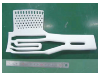
図6 SLS後二次焼結した中子 6)
