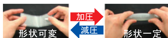
図1 柔軟な袋状構造の加減圧による剛性変化
