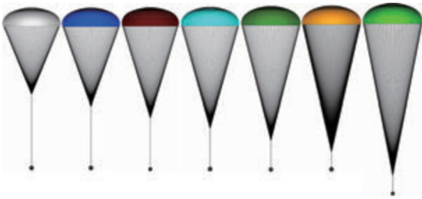
図9 シミュレーションによるデザインの決定 (サスペンションラインの長さによるパラシュートの挙動の違い)
