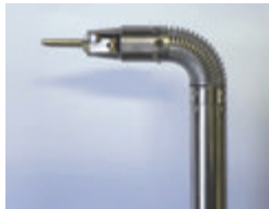
図4 柔軟関節機構を用いた鉗子マニピュレータ
