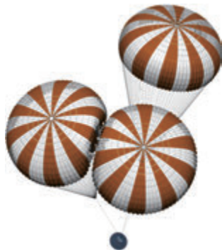
図10 クラスターパラシュートの計算結果 (2つのパラシュートがコンタクトしている時)
