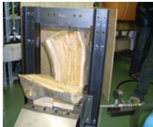
図8 低圧水圧駆動の薪割り機
