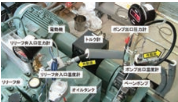
図2 評価試験装置の油圧源部
