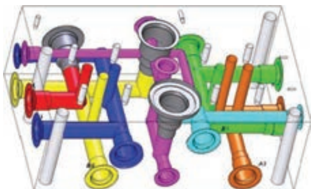
図1 マニホールドブロックの構造例
