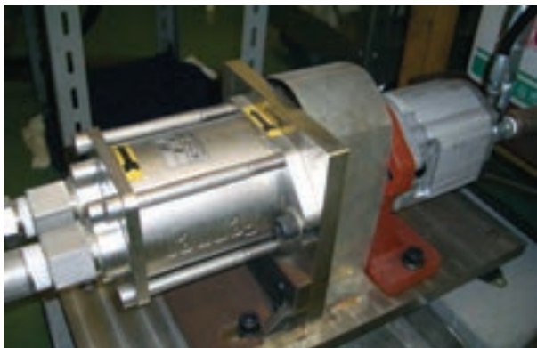
図3 実験用水圧源装置
