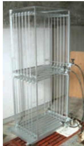
図4 70m 配管部 (保温カバー無)
