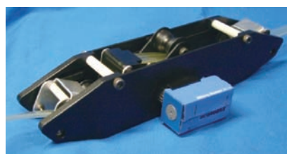
図2 無線カメラを搭載したゴンドラの外観
