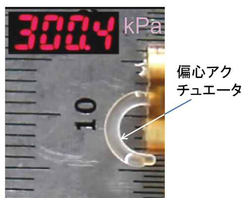
図2 高集積高圧マイクロポンプによる偏心チューブアクチュエータの駆動
