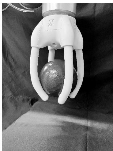
図6 ソフトロボットハンドで5kgの鉄球を把持している様子
