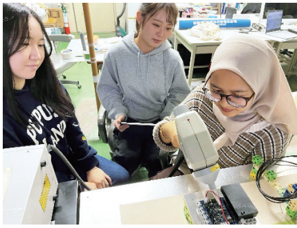
写真3 静電気放電によるロボット制御基板の誤動作の実験
