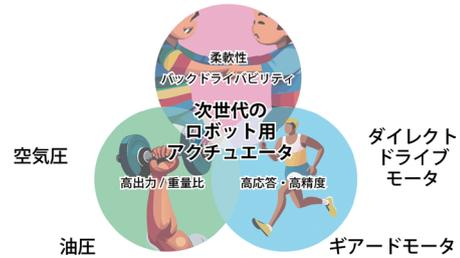
図1 ロボット用アクチュエータが持つべき特性
