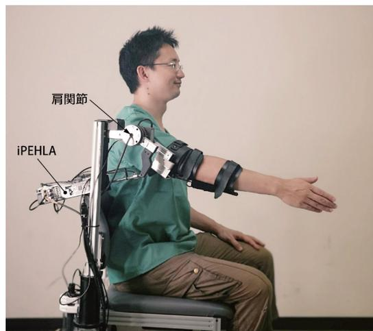
図6 開発中の肩関節挙上運動用外骨格型ロボットの試作機
