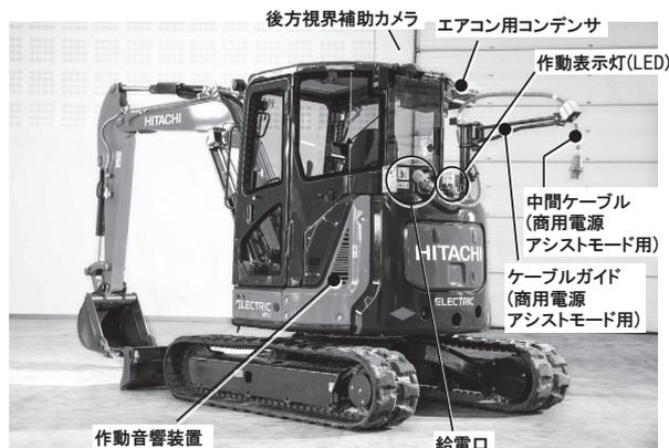
図1 開発したバッテリー駆動式ミニショベル外観
