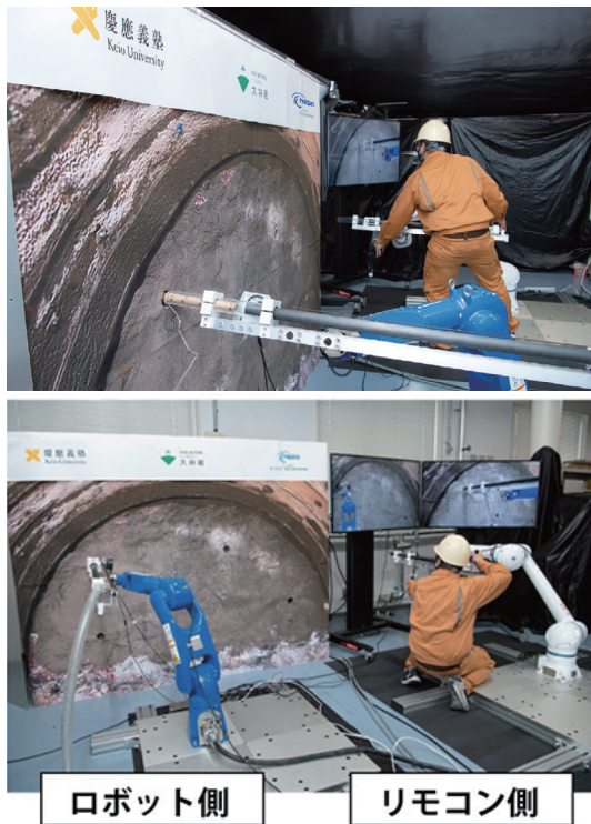
図9 リアルハプティクスを活用した山岳トンネル掘削作業用自動火薬装填システム
