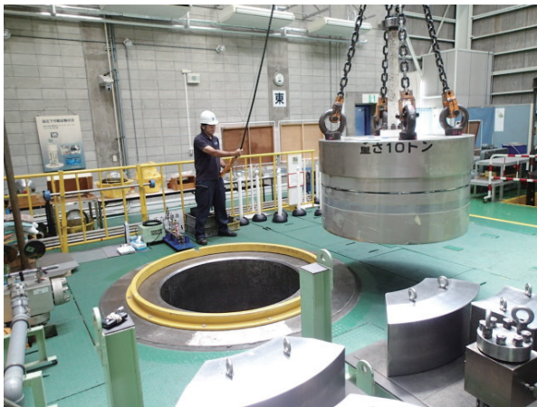
図2 大型高圧実験水槽地上部(上蓋吊り上げ作業中)
