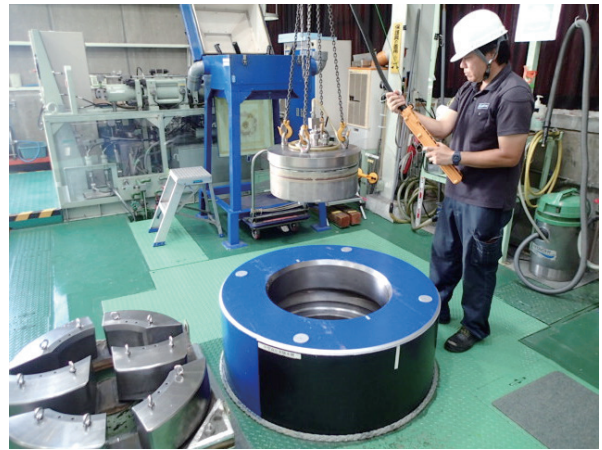
図4 中型高圧実験水槽地上部(上蓋吊り上げ作業中)
