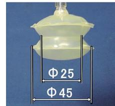
図14 EHD人工筋用蛇腹型の構造体
