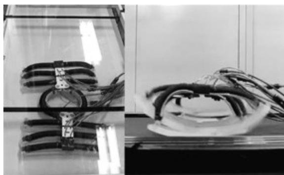
図3 湾曲型空気圧ゴム人工筋を用いた柔軟歩行ロボット
