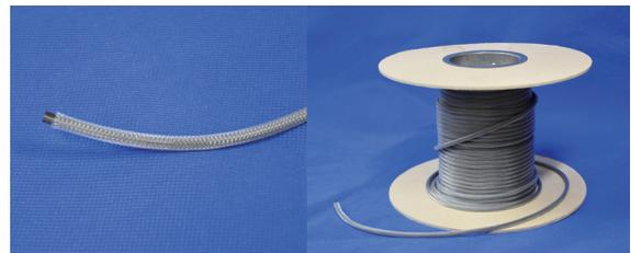
図1 細径マッキベン型人工筋肉. 図は4 mm径. 右図のようにロール状になっている状態から所望の長さを切り出し, 端末処理を施して使用する.
