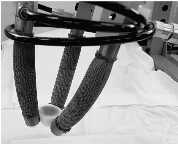
写真5 油圧駆動湾曲型ソフトロボットハンドでゆで卵を潰さずに把持している様子
