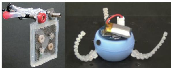
図3 水の電気分解と合成応用例。左図はインフレータータイプのアクチュエータ内部にPEFCが組み込まれており、電氣的に駆動制御が可能である。右図は胴体部にPEFCが組見込まれおり、上部には制御基板とバッテリーが搭載されている。
