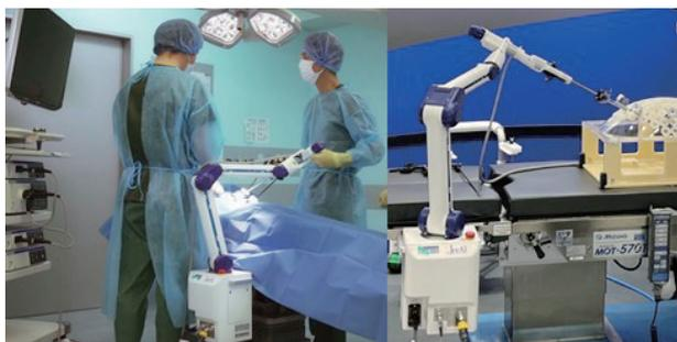
図1 空気圧駆動を用いた内視鏡操作支援ロボット
