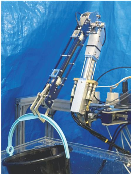
図5 水力君1号（3軸ロボット）
