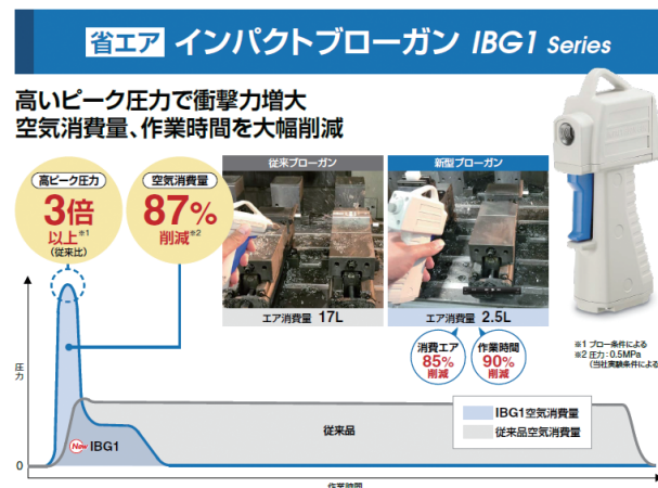
図10 インパクトブローガンの使用時の空気消費量削減事例
