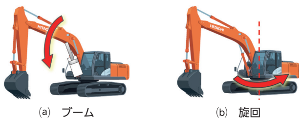
図2 油圧ショベルの回生可能エネルギー
