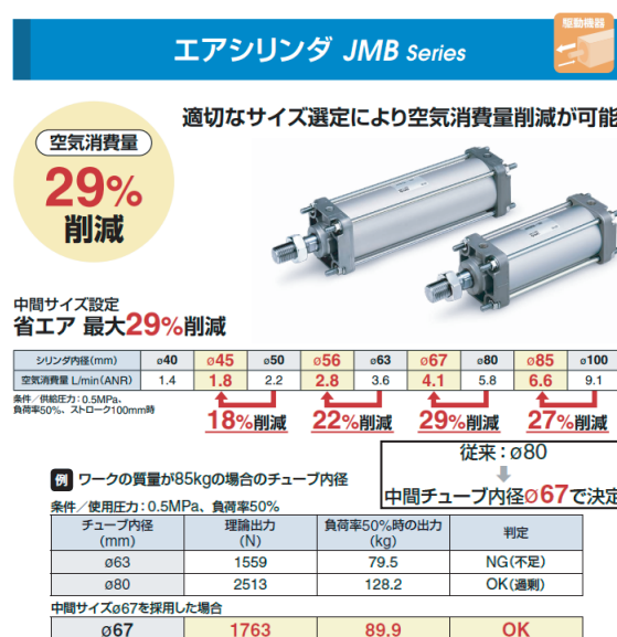
図7 中間サイズによるエアシリンダの空気消費量削減例
