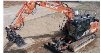
写真2 自律型建設機械向けシステムプラットフォームを適用した車体
