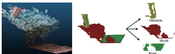
図7 デプスカメラで撮影した作業領域の3次元点群（左），AIによる植生と障害物の識別結果（右）
