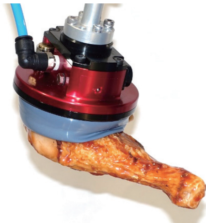
図6 バルーンハンド吸着例（擬似チキン）
