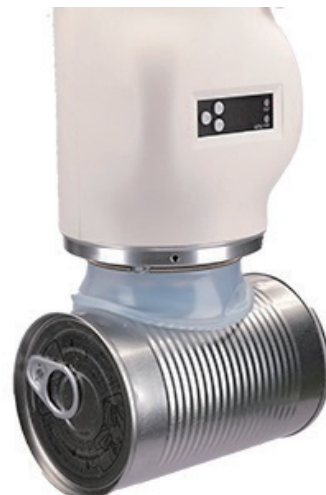
図7 電動バルーンハンド吸着例（缶詰）
