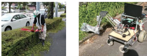
図6 人手による街路低木の剪定作業（左），試作した剪定作業用モバイルマニピュレータ（右）
