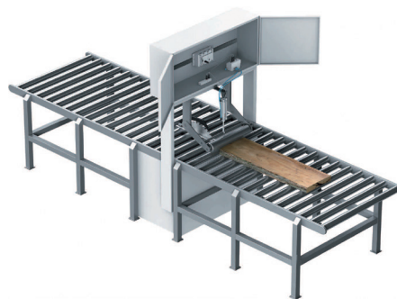
図8 木材加工に使用される空気圧サーボシステムの例
