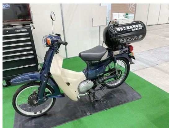
(b) エンジン評価用圧縮空気駆動バイク
