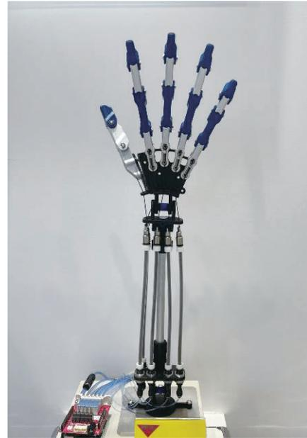
図5 人工筋駆動ロボットハンド
