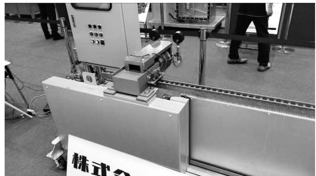
写真5 水圧駆動式横引きゲート
