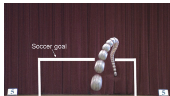
(a) 発射装置による弱回転魔球事例1, 初速 22.8 \text{ m/s} ( 82 \text{ km/h} )
