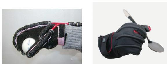
図4 パワーアシストグローブ [原型 (左) と商品 (右)]
