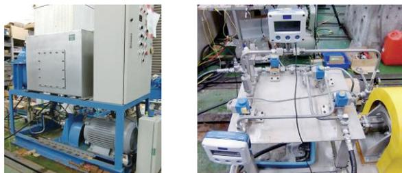
写真5 フルードスイッチングトランスミッション(実験装置)
