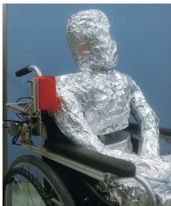
図6 車椅子座位姿勢補正システムとダミー人形
