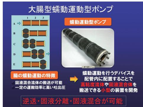
図5 大腸型ぜん動運動型ポンプの概要<sup>4)</sup>
