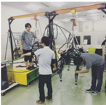
図2 ロボティクス・FAセンター内に間借りしている有料実験スペース(大型トレッドミルと4脚歩行ロボットが見える)
