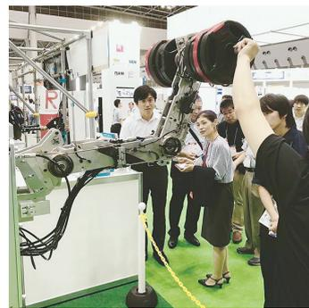
図4 低コスト汎用油圧機器で構成した油圧ハイブリッドマニピュレータの重力アシストデモの様子(IPFEX2017)
