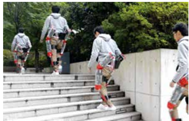
図9 空気圧人工筋肉によるアシスト装置
