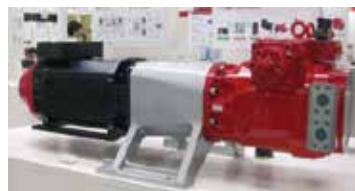
図1 油圧ポンプ回転数制御駆動源
