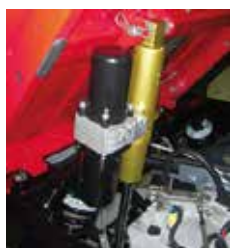
図5 小型油圧アクチュエータユニット
