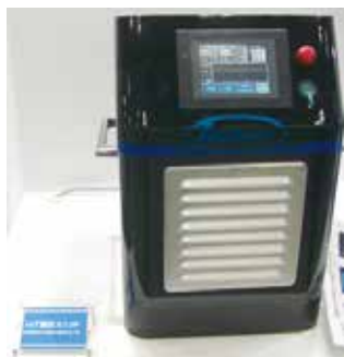
図11 IoT対応油圧ユニット
