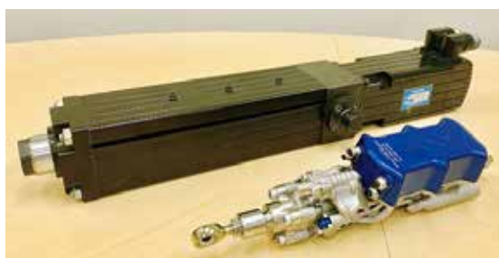
図6 ISAと電動アクチュエータの比較
