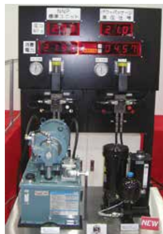
図2 油圧駆動源の消費電力の比較
