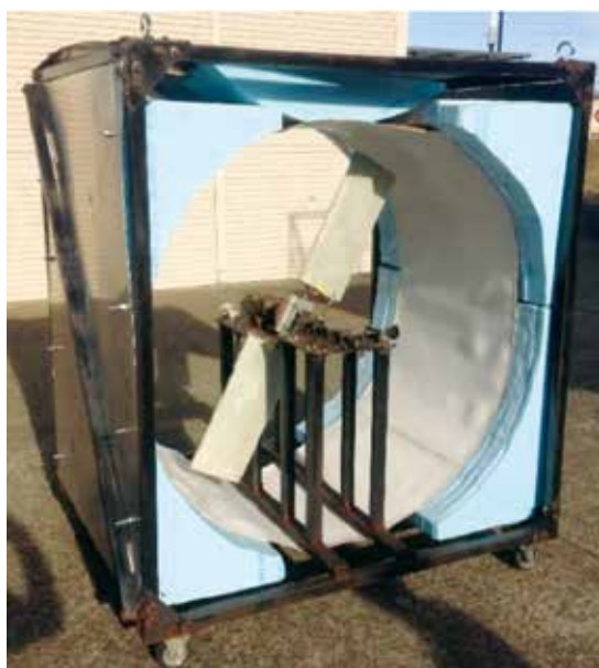
図5 プロペラを用いた空力制振システム 7)
