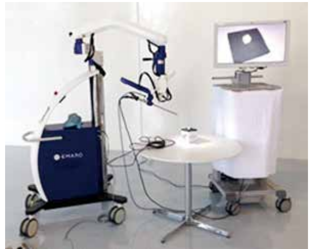
図8 空気圧駆動内視鏡操作システム
