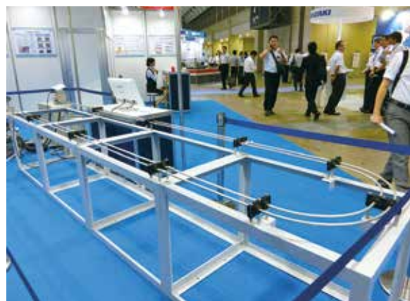
写真3 ウォーターハンマー試験装置
