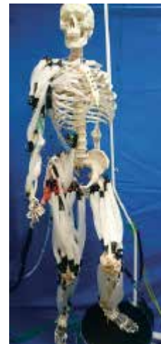
図12 細径空圧人工筋肉による筋骨格ロボット
