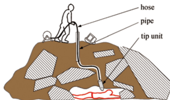
図11 土中探査ホースの作業イメージ
