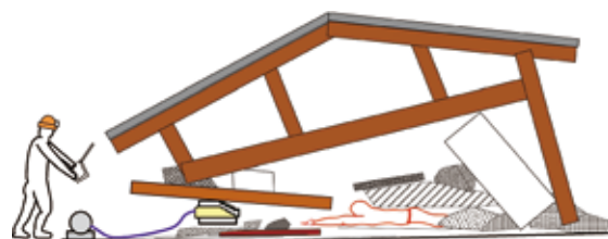
図1 ジャッキアップ移動体による救助のイメージ
