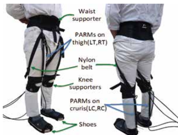
図6 空気圧ゴム人工筋の圧力変化から歩行意図検知を行う歩行アシストシステム
