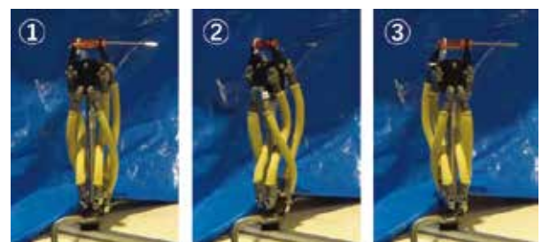
図7 油圧 (1MPa) での動作の様子
