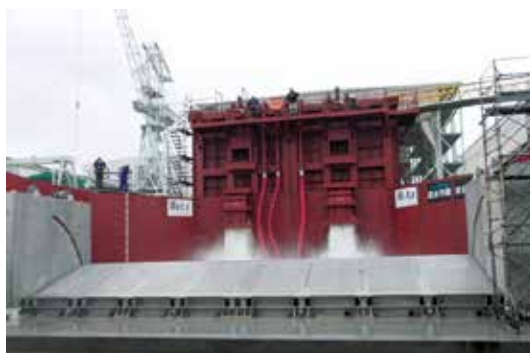
写真2 大型neo RiSe作動試験 (幅15m×高3m)
