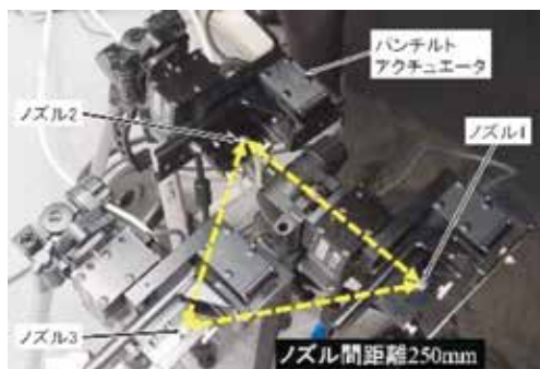
図3 エアージェットを用いた空間物体搬送
