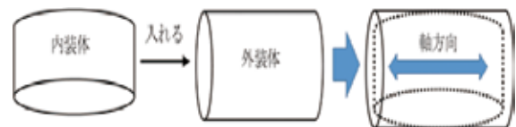
図2 全方向耐圧構造
