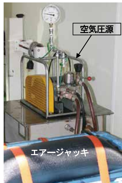
図4 エアージャッキの耐圧試験
