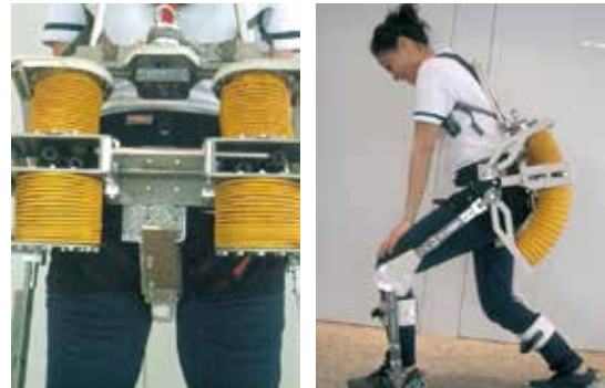
図3 仙骨およびサドルの機能を持たせたアルミ製尾骨部材を備えた腰装着部
