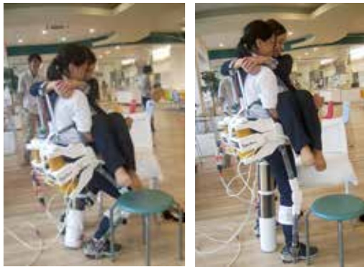
図8 ベローズ内蔵アクチュエータにより臀部のみアシストするパワーアシストスーツによる移乗作業
