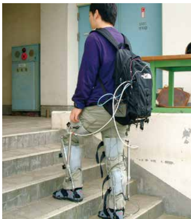
図1 空気圧歩行支援装具を使っているところ
