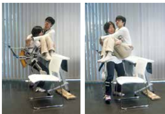
図5 膝関節にコイルばねを組み込んだパワーアシストスーツの着用実験, 移乗作業
