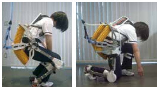
図4 膝関節にコイルばねを組み込んだパワーアシストスーツの着用実験, 可動範囲
