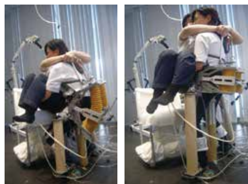
図7 ローズ内臓アクチュエータにより両脚および臀部をアシストするパワーアシストスーツによる移乗作業
