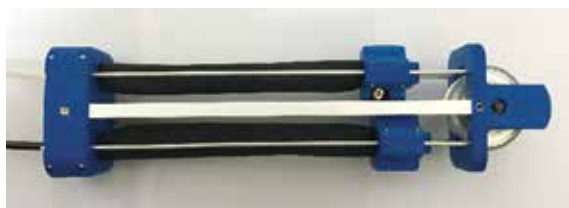
図4 試作したニュートラル機構の付いたゴム人工筋
