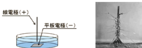
図4 EHD現象を発生させる電極構成の例
