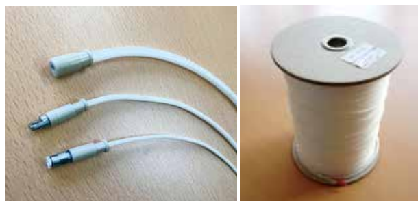
図1 細径人工筋肉の一例（左：端末加工品、上から外径4.5mm、2.5mm、1.8mm、右：ロール巻での出荷例）
