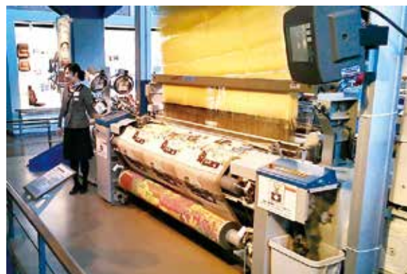
図8 空気流で横糸を送る高速織機
