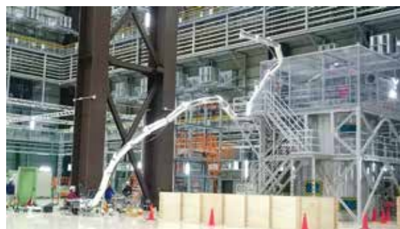
図4 細径委人工筋肉でしか実現できない超軽量20m長ロボットアーム
