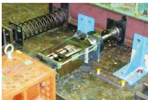
図9 MR流体コンポジットブレーキを用いた直動型減衰力可変ダンパの振動台免震試験時の設置状況
