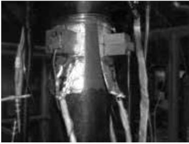
図3 配管試験部に取り付けたEMATプローブ
