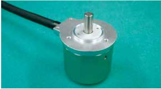
図5 磁気式エンコーダの試作品
