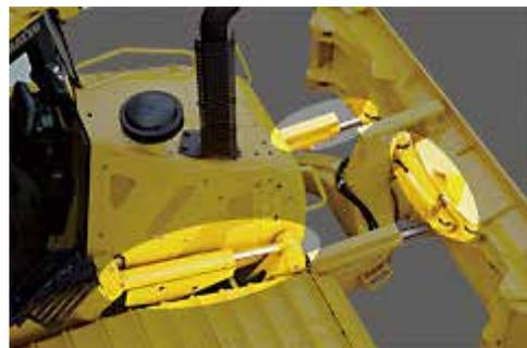
図3 ストロークセンサ付シリンダ
