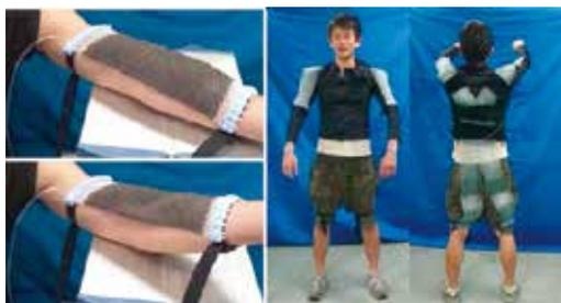
図1 細径人工筋を用いたパワーアシストスーツ<sup>1)</sup>
