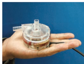
図1 試作した体内植え込みを目指す磁気浮上補助人工心臓
