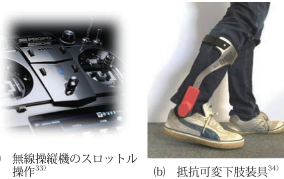
図9 ナノ粒子分散MR流体を用いたブレーキの実用化応用機器
