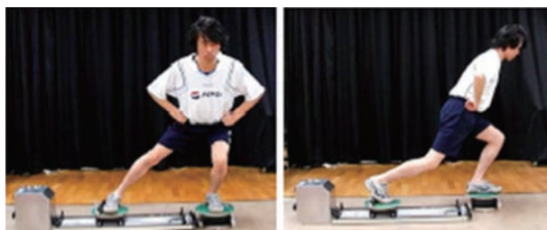
写真5 ER流体ブレーキ制御下肢トレーニング装置
