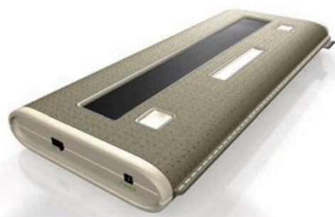
図4 ER流体バルブで駆動される点字ピンからなる3行点字表示システム（2048 dots/129文字，3行，サイズ：450×130×60mm） 11)
