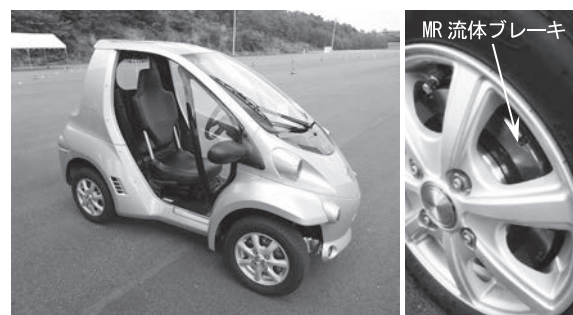
図6 MR流体ブレーキを装着した超小型EV(左)とその車輪(右)
