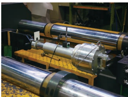
図8 MR慣性ダンパの加振試験状況
