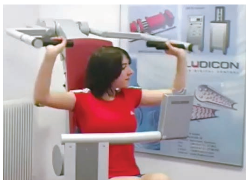
写真4 ERダンパーを用いたトレーニング装置
