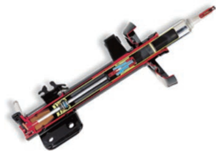
図6 MR流体ショックアブソーバの例(2002年米国D社開発・事業化→2009年中国B社へ事業部売却)
