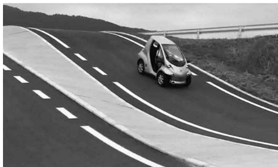
図8 MR流体ブレーキを装着した超小型EVが勾配30%坂道で一時停止している様子
