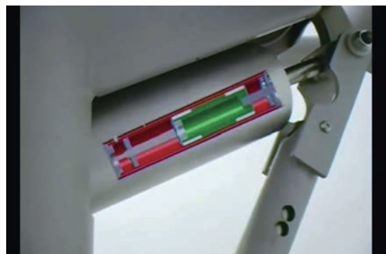
図3 シリンダー・ピストン型ERダンパの腕の筋力トレーニングシステムへの活用 12)
