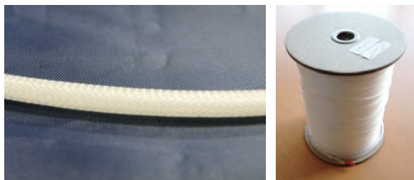
図3 細径人工筋（外径1.8mmのもの）
