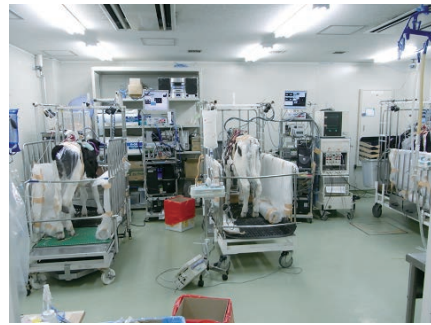
図5 東京医科歯科大学での補助人工心臓を用いた子牛による補助循環試験の様子
