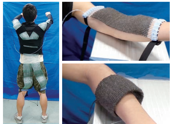
図4 身体サポートウェア（左：腰と上肢のパワーサポートスーツ、右上：前腕の動作サポート、右下：前腕圧迫具）
