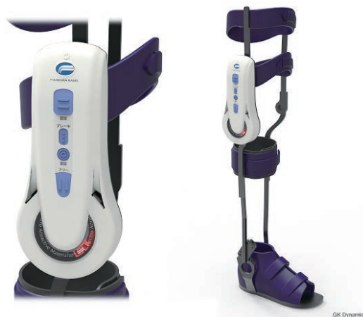
図5 KAFOに取り付けた電子制御EAM膝ブレーキ
