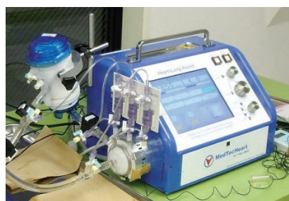
図6 臨床用体外設置磁気浮上補助人工心臓
