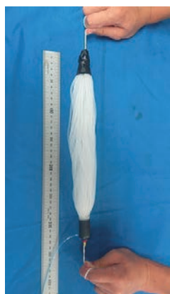
(a) 細径多繊維構造空気圧人工筋
