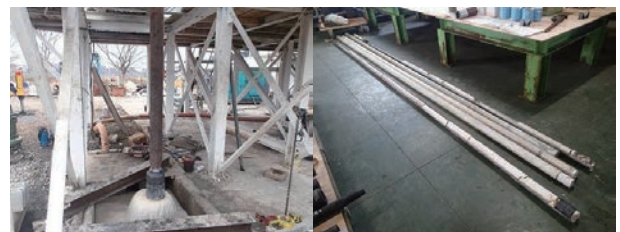
図9 コア採取試験（左）、採取したコア（右）
