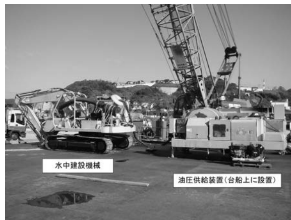
図4 船上から油圧を供給する方式の水中建機
