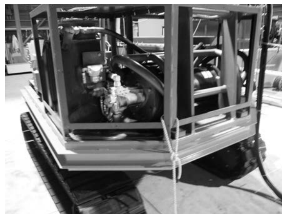
図5 水中電動モータにより油圧を発生させている
