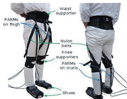
図3 内圧から歩行意図を検知するアシストスーツ
