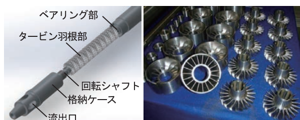
図3 タービンモータ（左）、静翼と動翼部（右）
