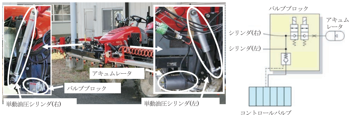
図1 乗用管理機搭載式ブームスプレーヤのHPSと回路
