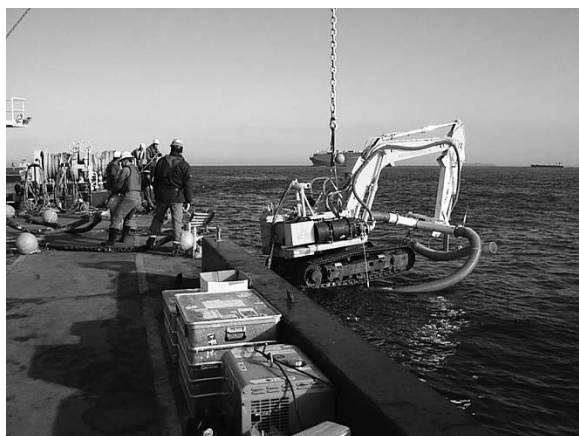
図3 ウォーターエゼクタを搭載した水中建機
