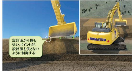
図11 最短距離制御
