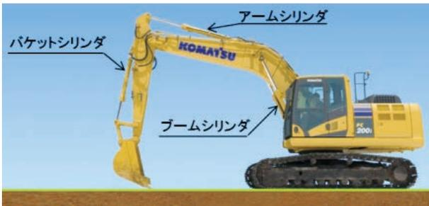
図4 作業機の油圧シリンダ
