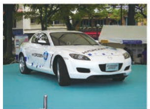
マツダ 内燃機関水素ロータリエンジン自動車 ガソリンのみで走行可 2006年
