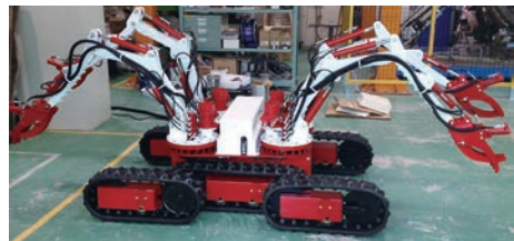
図3 試作したオクトパス (全油圧駆動)
