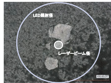
図5 固形異物に対する光検出エリアの比較
