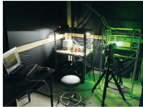
図3 EHD流れ場の測定装置
