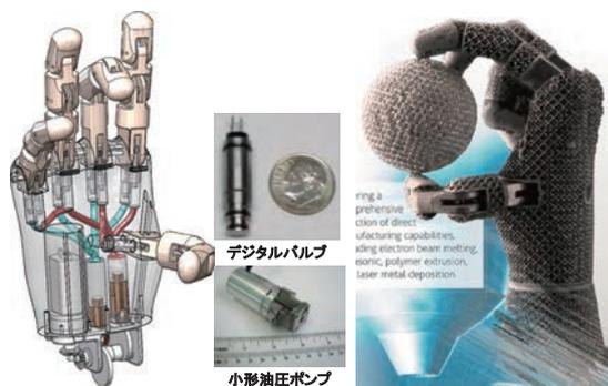
図1 油圧駆動小形ロボットハンド
