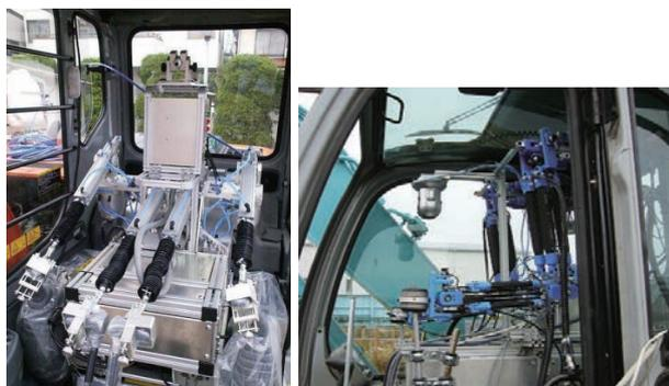
図2 建設機械遠隔操作用空気圧駆動ロボットアーム（左 空気圧シリンダ他を用いた2自由度アームが4本バージョン、右 空気圧ゴム人工筋を用いた6自由度アームが2本バージョン）
