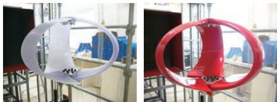
図10 VAWTの断面形状による性能差の比較 6)
