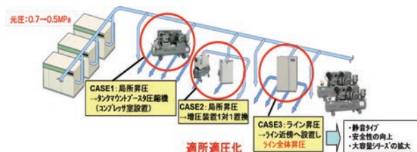
図4 従来の工場エアシステム
