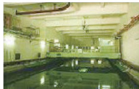
図7 船舶運航性能実験水槽 (L: 50m, B: 10m, D: 2m)
