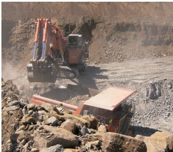
図1 オーストラリアの露天掘り鉱山で活躍する、積載量222トンのダンプトラックと、総質量522トンの油圧ショベル
