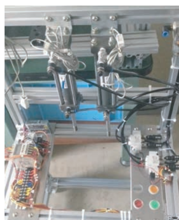
図4 空気圧シリンダーのメータアウト回路
