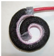
図6 湾曲型空気圧ゴム人工筋（加圧時）
