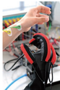
図8 商品化されたパワーアシストグローブ
