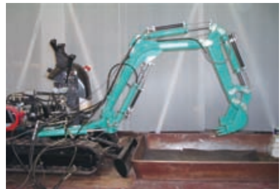
図9 パワーショベルの実験機
