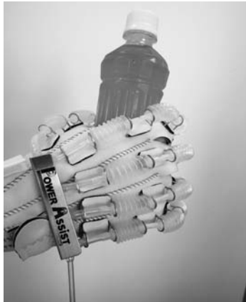
図4 ボトルの把持動作のアシスト
