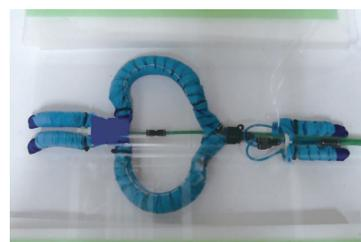
図3 湾曲型空気圧ゴム人工筋を用いた狭あい部移動ロボット
