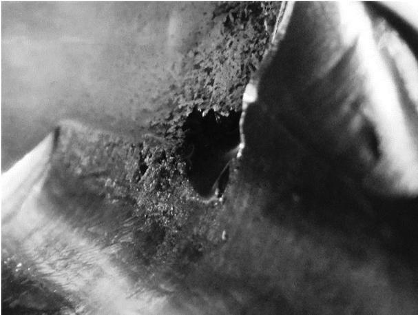
図7 エロージョンによるポンプ破損
