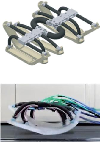
図4 湾曲型空気圧ゴム人工筋を用いた柔軟歩行ロボット
