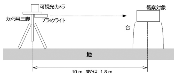
図2 屋外での装置設置概要
