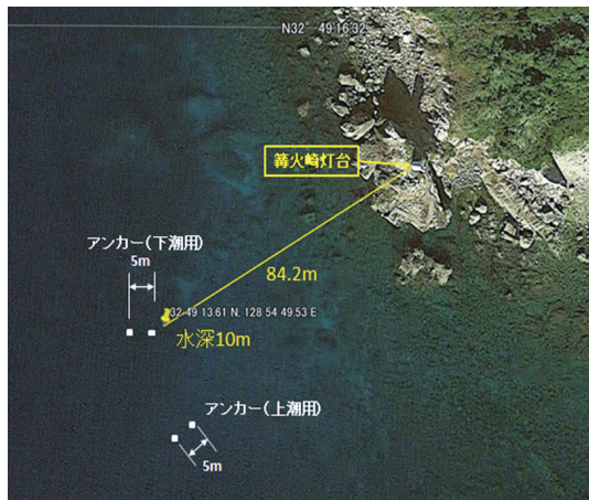
図9 アンカー設置位置と電力線敷設
