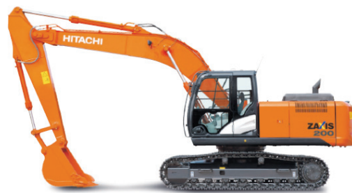
写真1 3ポンプシステム搭載の20t油圧ショベル
