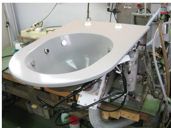
図1 鉄道車両用真空式トイレ
