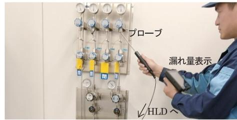
図7 スニッファー法による配管試験例
