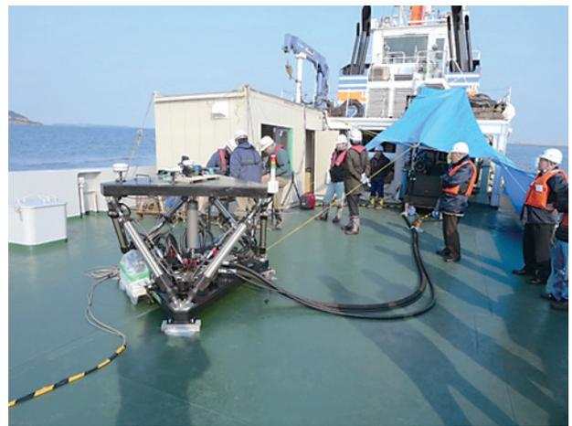
写真4 油圧動揺吸収装置の海上実証実験
