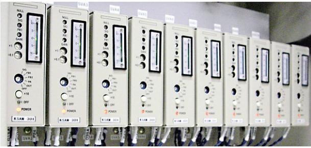
写真1 油圧サーボアンプの導入例（10軸制御）
