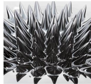
図1 磁場に反応する磁性流体
